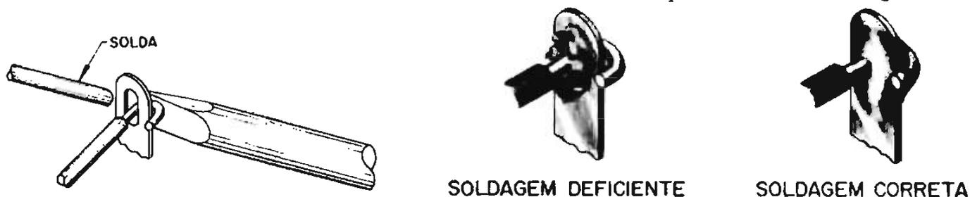
Figura 4 - Detalhes da ligação e soldagem a terminais
